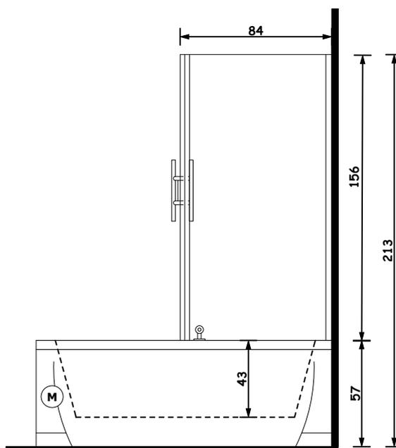
Motore Idromassaggio M Whirlpool Motor
